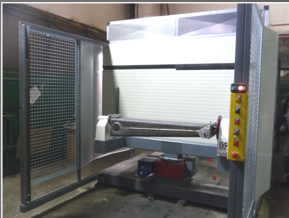
Роботизированная сварка деталей гидроманипуляторов
