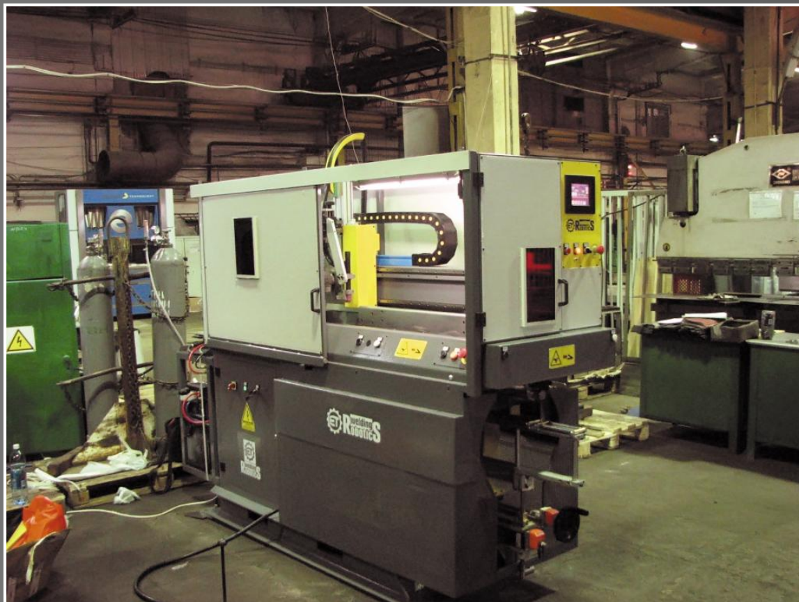
Машина автоматической TIG сварки продольных швов труб дымоходов из нержавеющей стали
