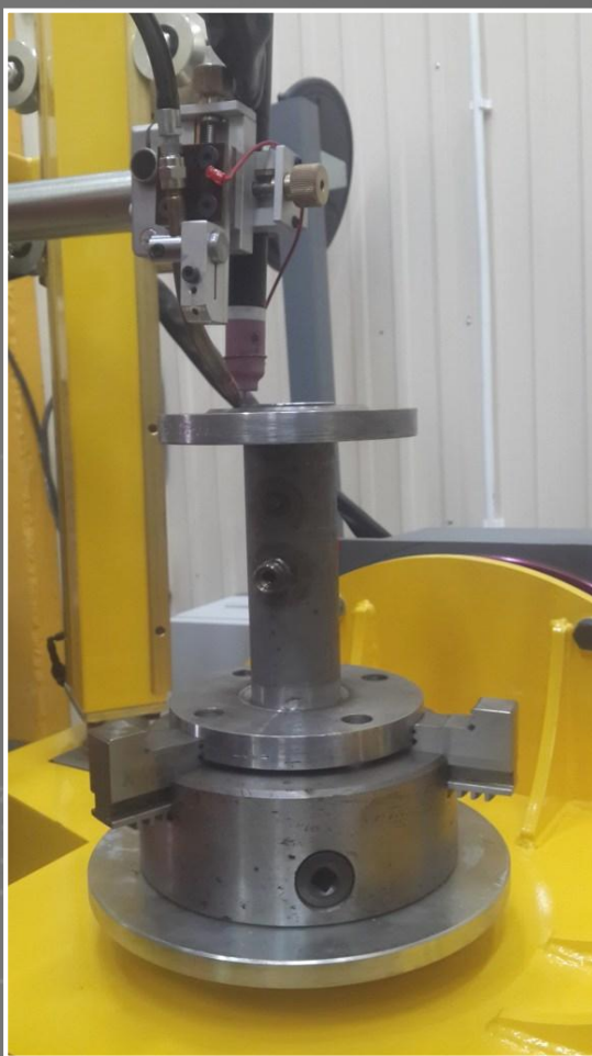
Машина для автоматической сварки кольцевых швов (TIG с подачей присадочной проволоки)
