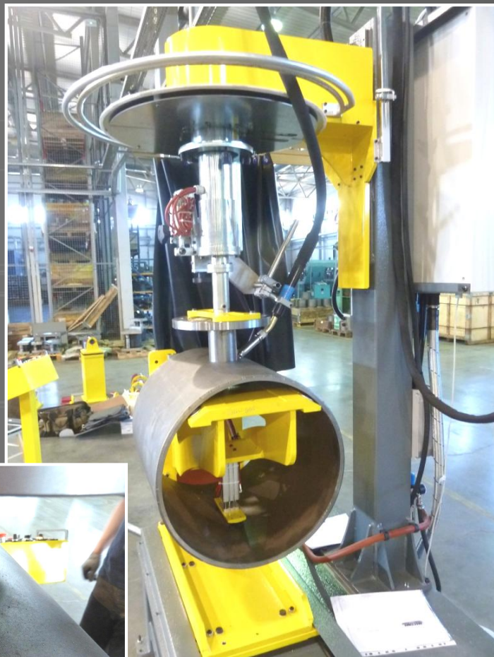
Машина для приварки втулки штока к корпусу шаровых кранов
