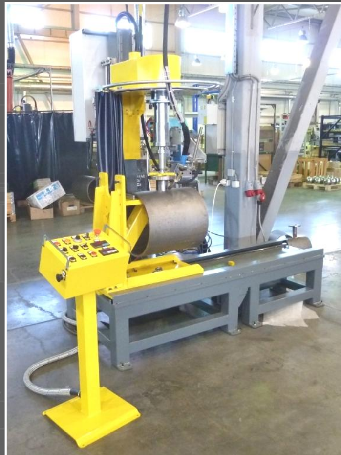
Машина для приварки втулки штока к корпусу шаровых кранов
