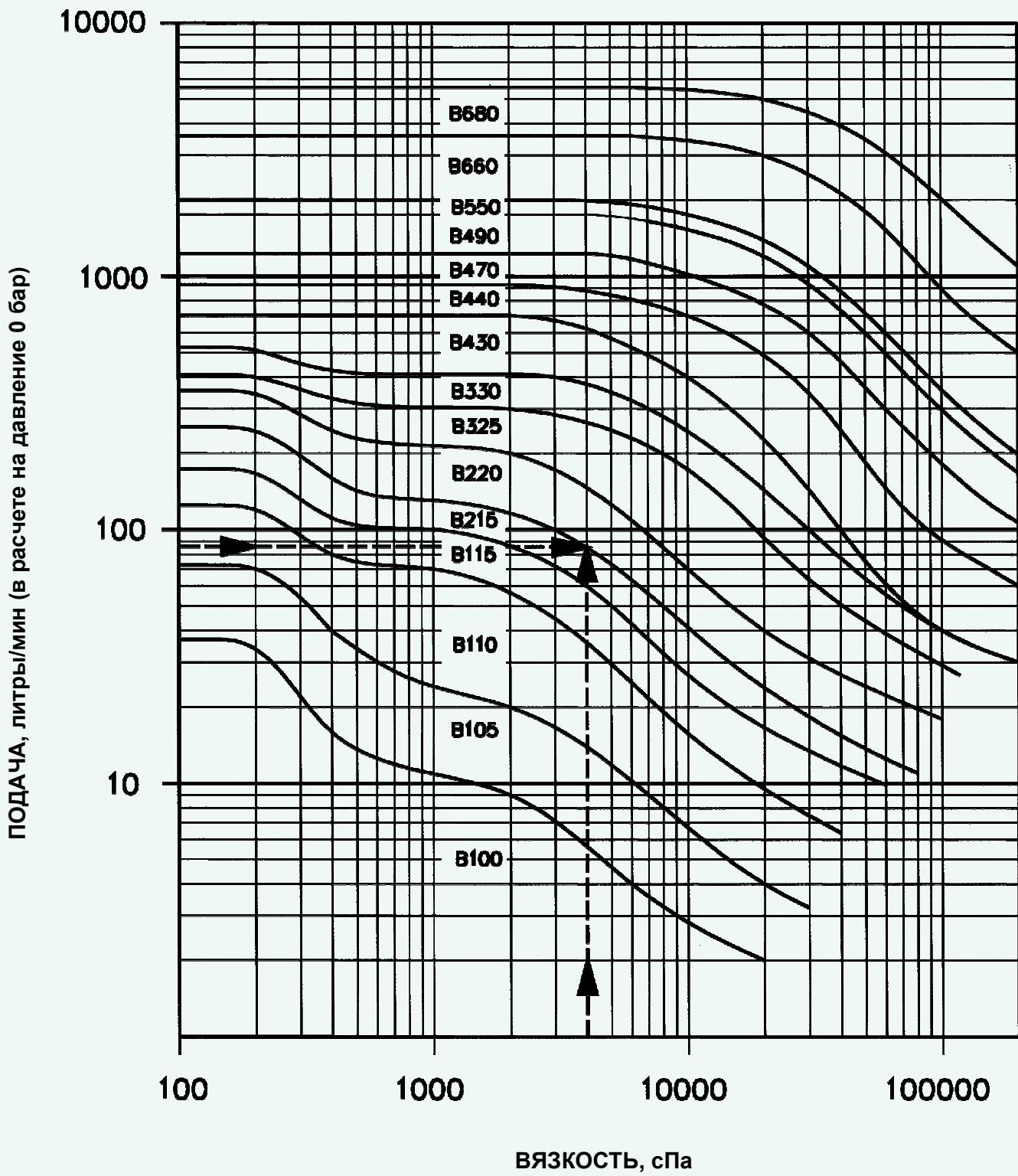
Кривые на этой диаграмме ограничивают область применения насосов различных типоразмеров, выбранных в первом приближении в зависимости от вязкости / подачи. Например, при: вязкости = 4000 сПа подаче = 85 литров/мин
