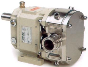
В тех случаях, когда есть необходимость поддерживать температуру перекачиваемой жидкости постоянной, на насосах всего ряда типоразмеров, за исключением B100, можно применять корпуса с предусмотренными в них полостями, по которым будет осуществляться циркуляция нагревающей или охлаждающей жидкости. Типичными являются случаи перекачивания глюкозы, шоколада, расплавленных жиров, масла, маргарина и т.д.
