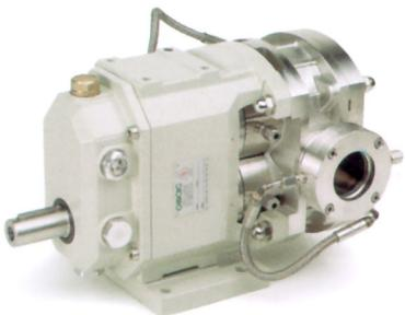
Для всех моделей насосов предусмотрены также асептические варианты исполнения, со стерильным паровым или жидкостным барьером на крышке, на механических уплотнениях и на патрубках. Асептический коловоратный насос применяется при выполнении технологических процессов расфасовки пищевых продуктов или фармацевтиче-
